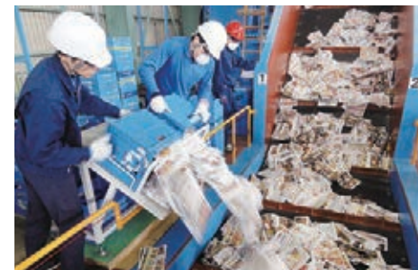
大型圧縮機では、1tの古紙の塊を作っています。異物などは職員の手で取り除きます。
